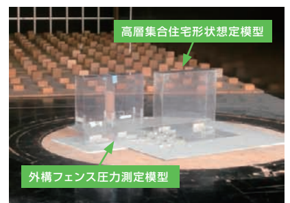
風洞実験状況
